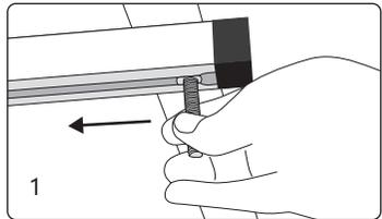
4. Faites glisser les boulons en T dans le trou central du rail, avec la patte de fixation en U, la rondelle en arc M8, la rondelle plate M8, l'écrou en plastique légèrement vissés à l'avance (2).
